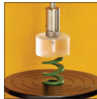
TA-11 Испытание пружины измерение зависимости силы от хода пружины
